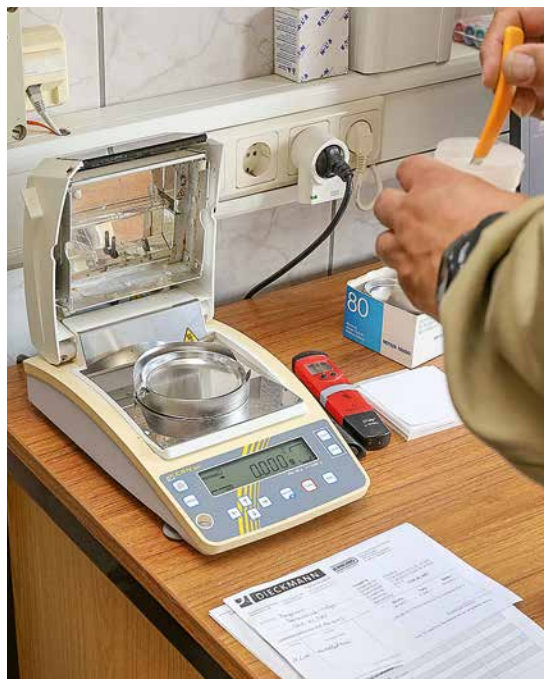
Links: Die Nebenprodukte sollen niedrige pH-Werte aufweisen. Rechts: Ein digitales Messgerät ermittelt den TS-Gehalt.
